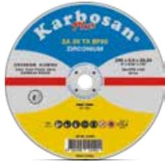
Convient pour le découpage de toutes les pièces en fonte nodulaire, de certaines pièces en acier moulé, des aciers inoxydables et des aciers fortement alliés. Comprend des grains abrasifs d'oxyde de zirconium et une structure dure. Offre l'avantage d'une durée de vie prolongée puisqu'il peut continuer à couper sans s'émousser et offre un meilleur enlèvement de matériel.
