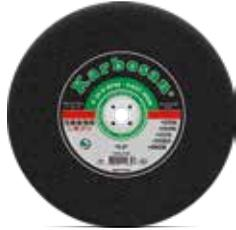
Convient pour la coupe de fonte à graphite sphérique (fonte nodulaire), fonte grise, aluminium, cuivre, laiton, bronze, etc. métaux non ferreux. Doté de grains abrasifs en carbure de silicium et d'une structure dure, le produit offre une longue durée de vie pour les procédés de coupe de matériaux coulés et non ferreux.
